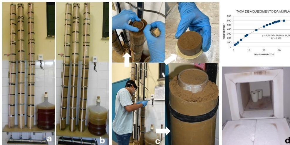
Figura 1 - Ensaios de ascensão capilar ((a) antes e (b) durante); coleta (c) e calcinação (d) do solo para montagem da curva de retenção
