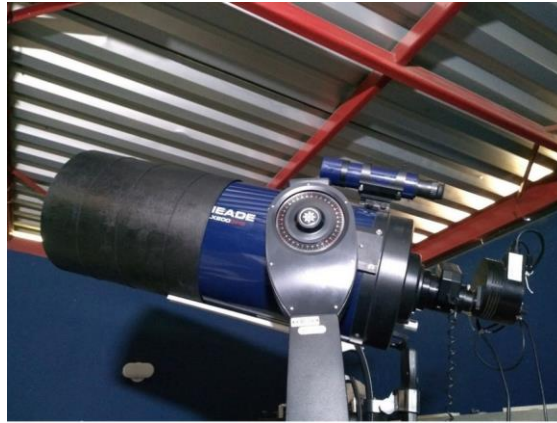
Figura 1: Telescópio empregado no estudo observacional. Meade LX200 GPS (24,5 cm) + CCD SBIG ST-7 (765 x 510 pixels). Fonte. Autor.
