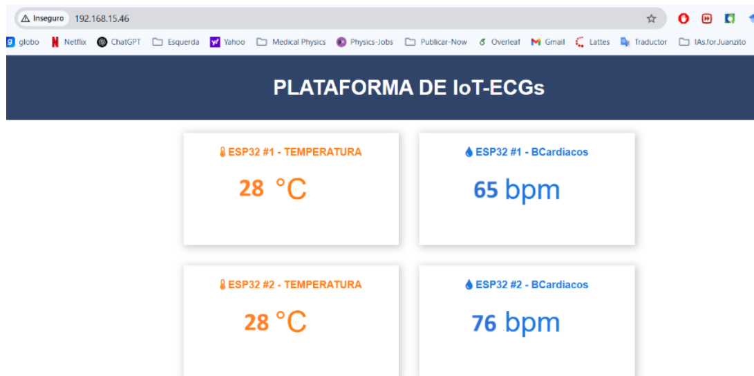
Figura 2: Interfase IoT para visualização das taxas das frequências cardíacas, e das temperaturas medidas pelas placas ESP32 Board #1 e ESP32 Board #2.
