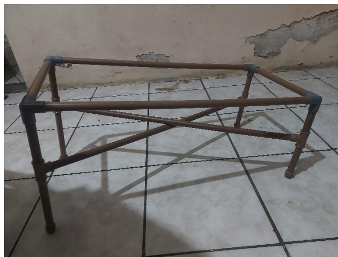
Figura 2: Vista lateral da base do sistema hidropônico com elevação aproximada de 25° em relação à horizontal. Fonte: Autoria própria
