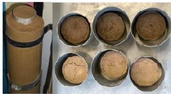
Figura 3 — Densidade e umidade, após ensaio de infiltração, ao longo da coluna de solo do CIS compactada
