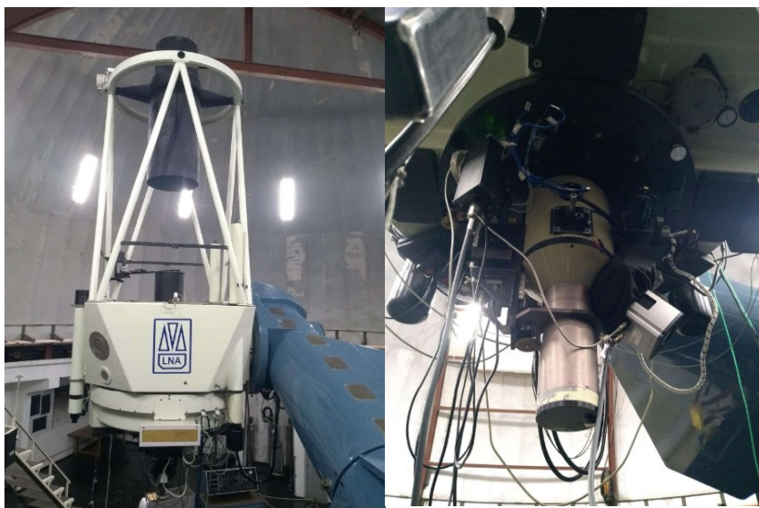
Figura 2: Telescópio Perkin & Elmer (1,60 m ) com o espectrógrafo Cassegrain no plano focal. O detector usado foi Ikon 27308 (2048x2048 pixels).
