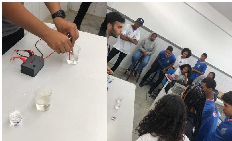
Figuras 1 e 2 - Teste de condução em solução salina e explicação do fenômeno
