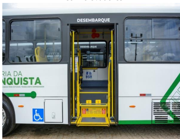
Figura 2: Ônibus que circula atualmente no município de Vitória da Conquista, equipado com elevadores
